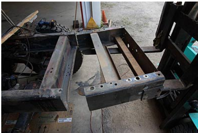
590mm découpés à l'arrière du châssis.
