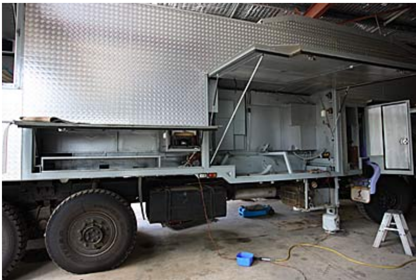
Les coffres de stockage ont été vidés, la grue de la moto, la cabine du générateur et les bouteilles de gaz, enlevés.
