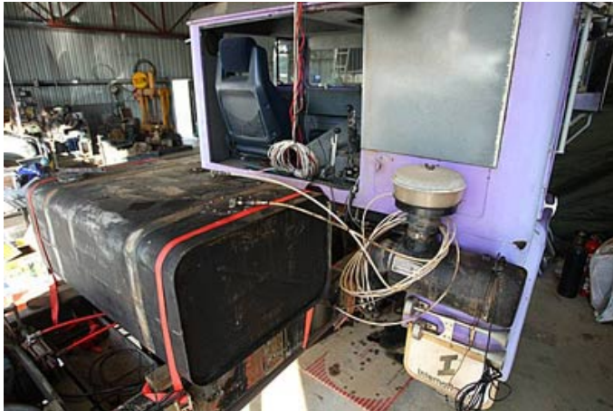
Un des réservoirs fixé derrière la cabine.
