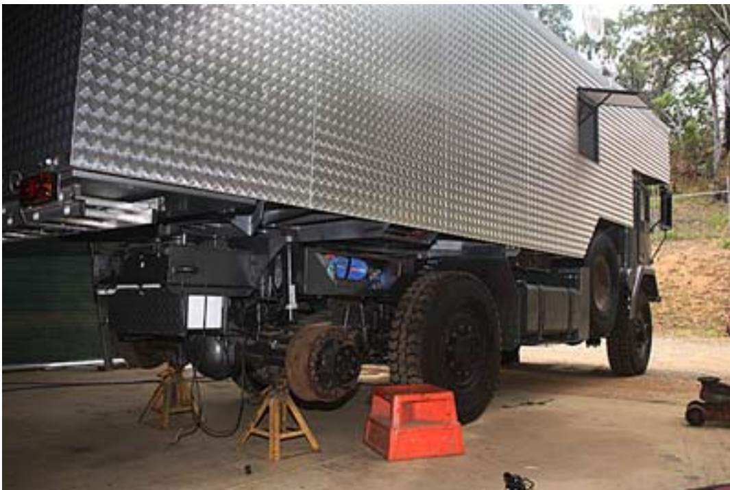
Deux des roues arrière démontées pour le montage des amortisseurs.
